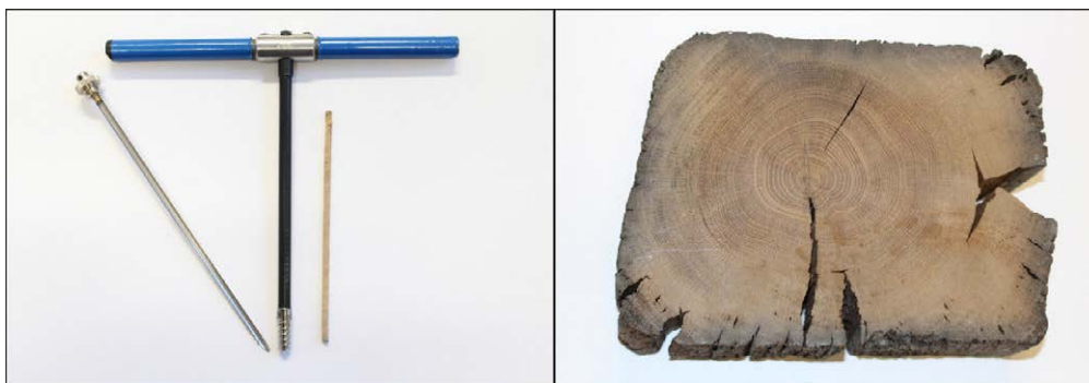
Obr. 20: Presslerův přírůstkový nebozez (vlevo) a příčný řez trámem (vpravo)
