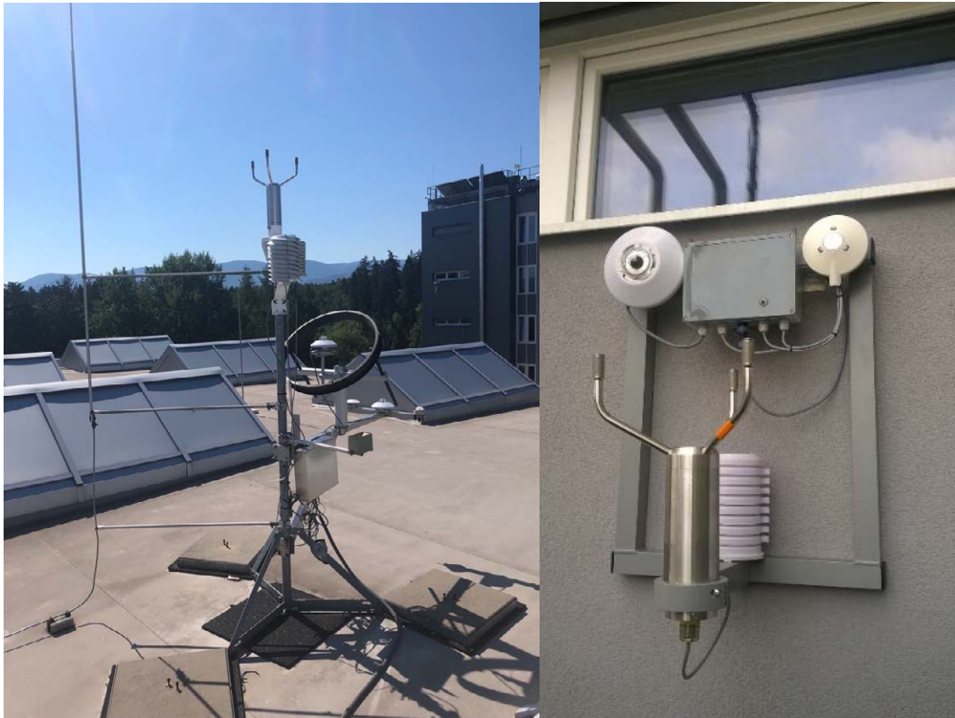
Obr. 167: Meteostanice – vľavo pevne stojaca, vpravo mobilná
