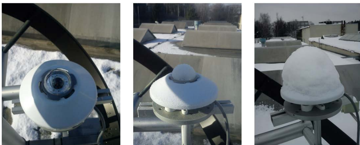
Obr. 89. Pyranometer tienení prstencom pre meranie difúzneho slnečného žiarenia vyžaduje každodennú údržbu, najmä v zimnom období
