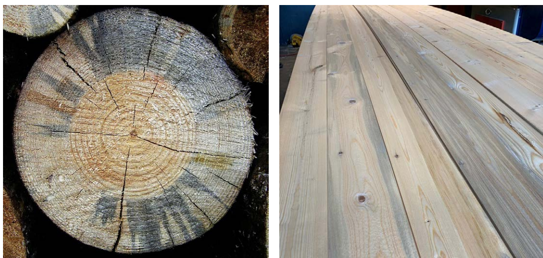
Obr. 28: Dřevozbarvující houby – „zamodráním“ běle borové kulatiny (vlevo) a jehličnatého řeziva (vpravo)
