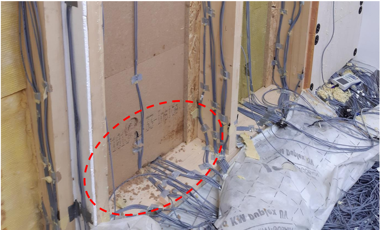
Obr. 118: Priesak vody z exteriérového prostredia v prípade skladby V3
