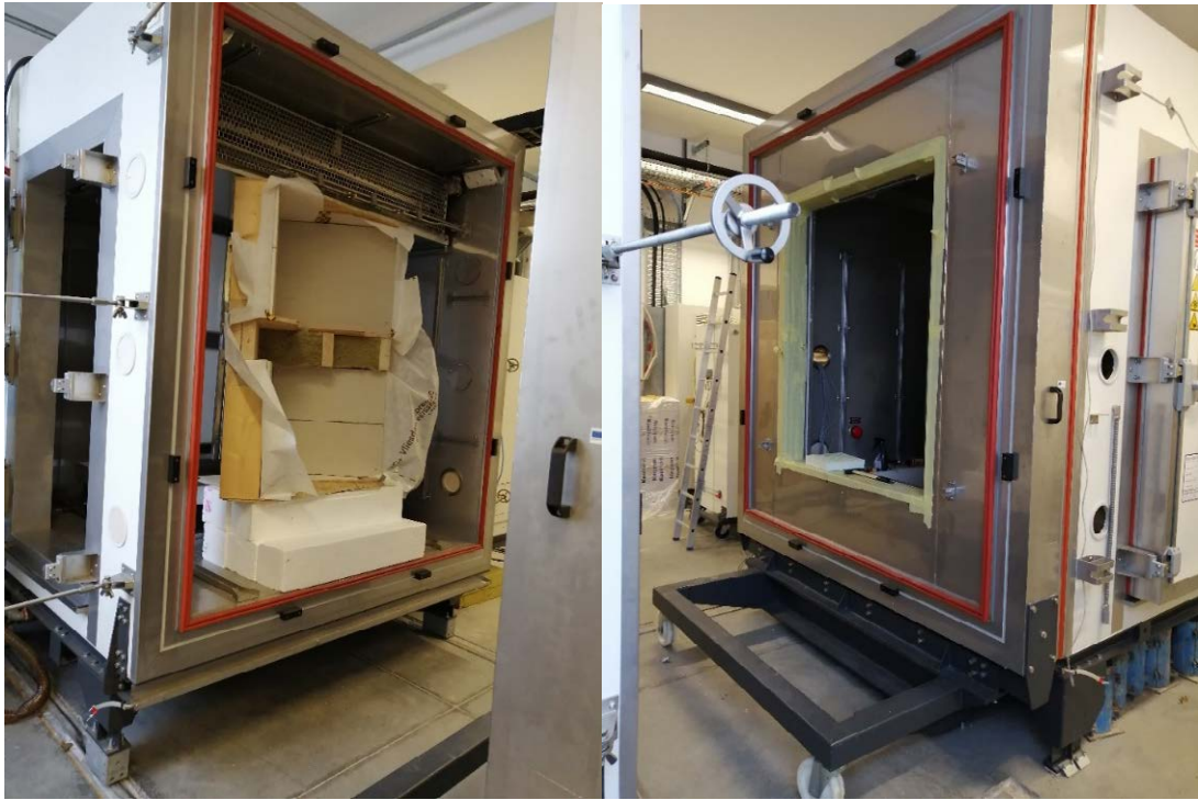
Obr. 125: Umiestnenie fragmentu do klimatickej komory
