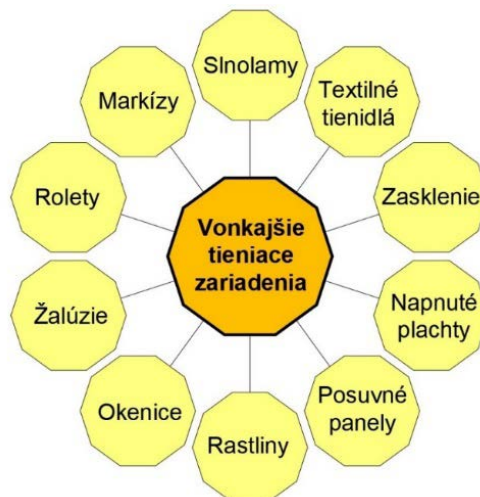
Obr. 139: Vonkajšie tieniace zariadenia [16]
