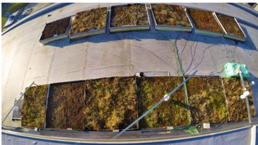
Obr. 165: Experimentálne vzorky extenzívnych vegetačných striech
