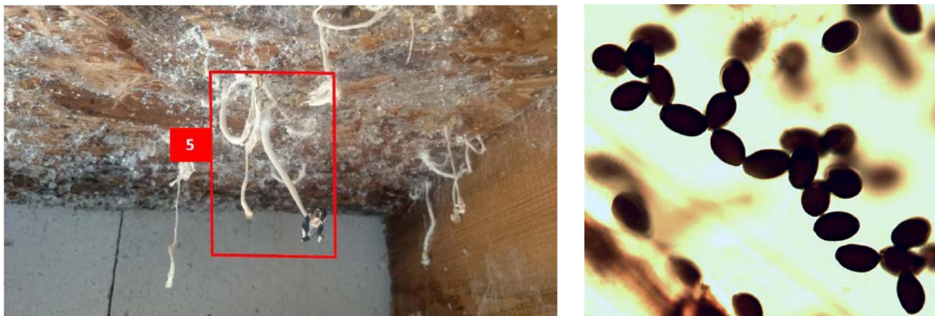
Obr. 81: Odobratá vzorka huby pre zisťovanie druhu a výtrusy plodnice zisteného hnojníka, rozmer výtrusov 9,99-13,1 \times 6,1-8,1 \mu\text{m} [1]
