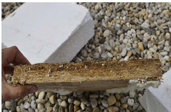
Obr. 73: OSB doska umiestnená pod parozábranou v rámci plochej strechy zachytáva kondenzáciu na spodnom povrchu, v krátkom čase začne zväčšovať svoj objem a degradovať hnilobou
