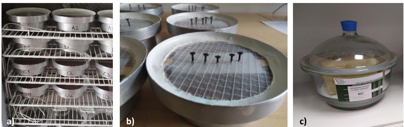
Obr. 45: a) komora s difúznymi miskami b) difúzne misky pre štúdiu vplyvu perforácií parozábran c) kondicionovanie vzoriek pri meraní sorpcie
