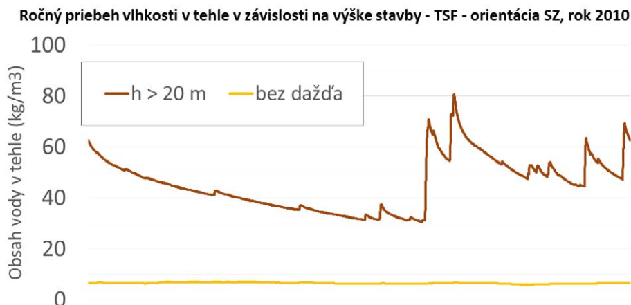
Obr. 104: Výsledky simulácie nezateplenej tehlovej steny pre miesto vo výška do 20 m nad terénom s uvažovaním vetrom hnaného dažďa a bez.
