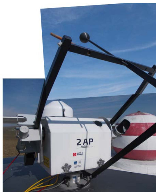
Obr. 89. Pyranometer tienení prstencom pre meranie difúzneho slnečného žiarenia vyžaduje každodennú údržbu, najmä v zimnom období
