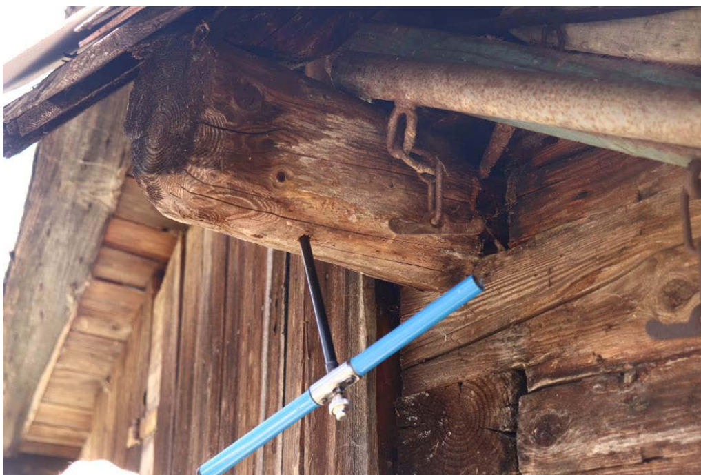
Obr. 21: Odběr vzorků Presslerovým přírůstovým nebozezem v místě podkorního letokruhu směrem ke středu konstrukčního prvku
