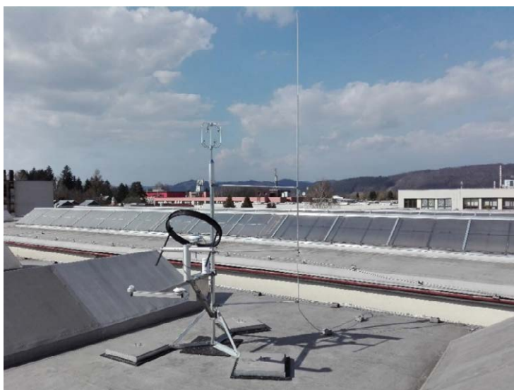
Obr. 107: Samostatne stojaca meteorologická stanica, umiestnená na streche budovy laboratórií, severne od budovy Výskumného centra
