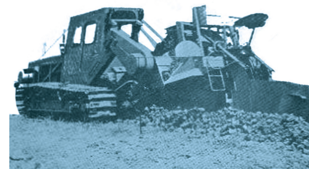
Drenážní rýhovač. Speciální přístroj na pokládku drenáží.
