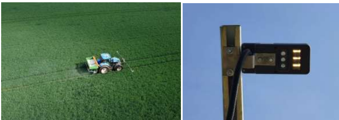
Obr. 20 Testování plodinového senzoru AgLeader OptRx v soupravě s rozmetadlem pevných minerálních hnojiv (vlevo) a detail na senzоровou jednotku systému (vpravo)
