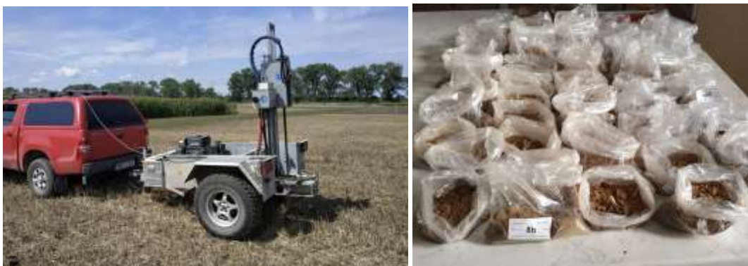
Obr. 22 Odběr vzorků půdy s využitím vzorkovací soupravy Nietfeld Duprob60 (vlevo) a prosté sušení odebraných vzorků na vzduchu (vpravo)
