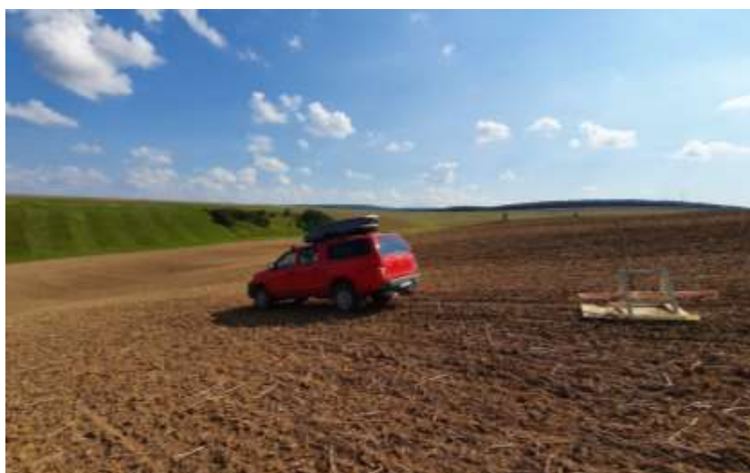
Obr. 10 Příklad provádění měření elektromagnetické indukce půdy – měřicí souprava sestávající se z měřicího přístroje GF Instruments CMD–MiniExplorer 6L taženého na plastových saních za terénním vozidlem (lokalita Rašovice, 2021)
