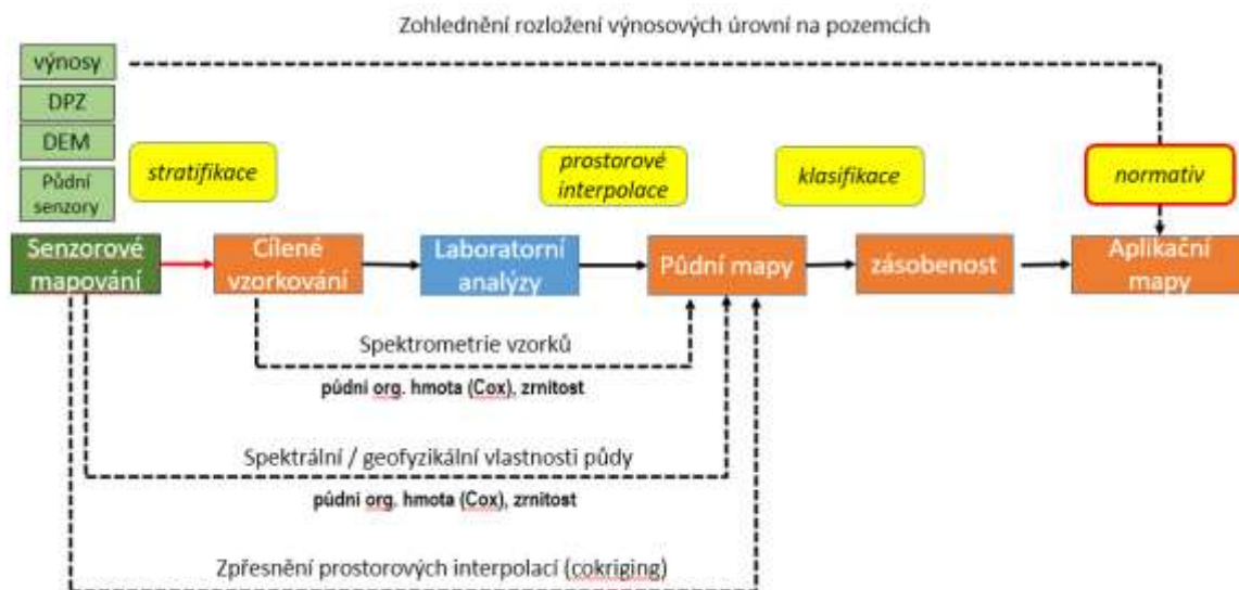
Obr. 11 Schéma postupu mapování nevyrovnanosti půdních podmínek v precizním zemědělství s využitím metod digitálního mapování půdy se zohledněním rozložení výnosových úrovní (Lukas et al., 2018b)
