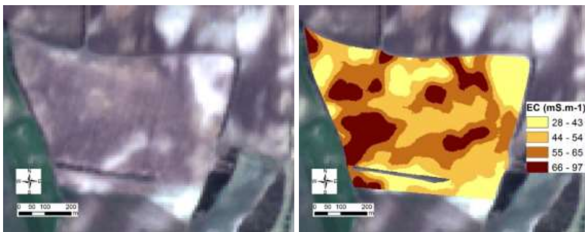
Obr. 9 Snímek holé půdy na 38 ha pozemku z družice Sentinel-2 z dubna 2017 (vlevo) a mapa elektrické vodivosti půdy z pozemního měření na jaře 2016 (vpravo). Obě metody identifikují vysokou plošnou variabilitu půdních podmínek. Zatímco družicový snímek je silně ovlivněn svrchní vrstvou půdy a vegetačním krytem, měření elektrické vodivosti vyjadřuje také vertikální změny půdy v půdním profilu bez ohledu na pokrytí půdy vegetací nebo třeba sněhem.
