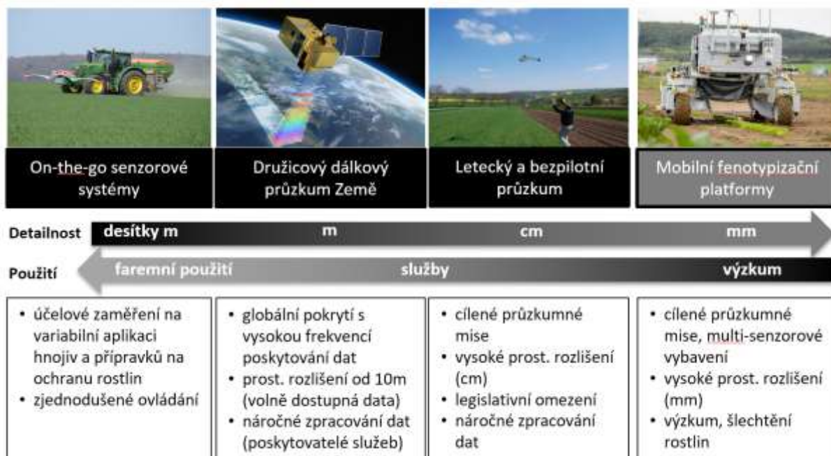
Obr. 13 Příklady metod spektrálních měření porostu a jejich vlastnosti spojené s využitím v zemědělství
