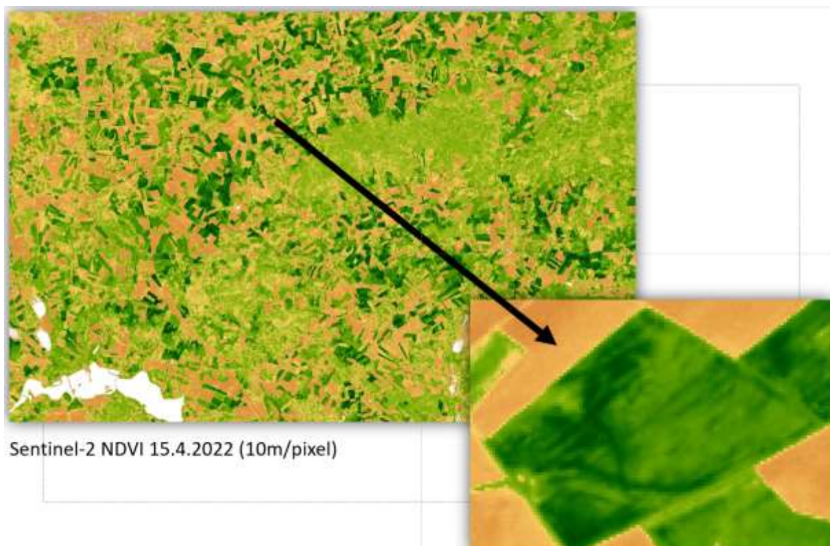
Obr. 6 Prostorové rozlišení 10m / pixel multispektrálních družicových dat Sentinel-2 dovoluje dostatečně zachytit prostorové rozdíly chování vegetace na zemědělské půdě.
